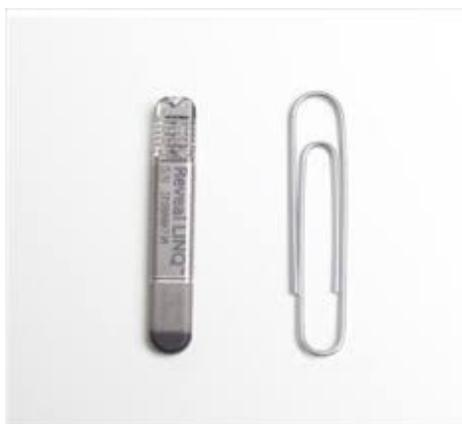
Enregistrement en boucle, il a une mémoire d'une heure...possibilité d'activation manuelle, avec récupération de l'événement 14 minutes avant son déclenchement et 1 minute après.
